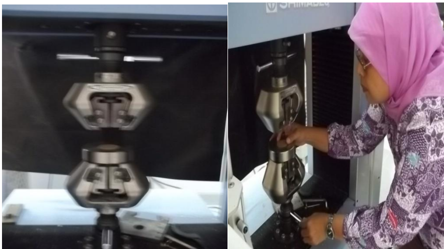
Gambar 4.4A .Alat Uji Tekan Gambar 4.4B. Proses Uji Tekan
