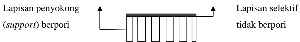
Gambar 2.4. Skema struktur membran komposit (Susanto dan Ulbricht, 2009)
