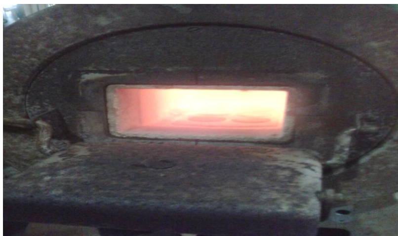
Gambar 10. Membran hasil Proses Kalsinasi pada T = 1100^{\circ}\text{C}
